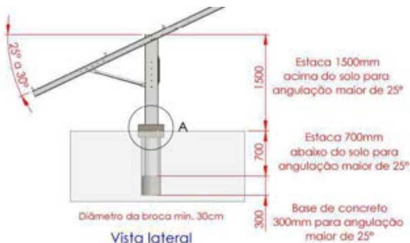
Figura 4 - Detalhamento fundação da estrutura metálica
